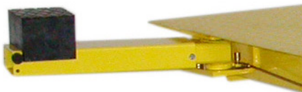
Die teleskopierbaren Aufnahmearme sind innerhalb der Stellfläche des Fahrzeugs, zur Sicherheit von Personen, die in der Nähe des Fahrzeugs arbeiten.
