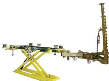
**MASB35.10TFL08** JOLLIFT Hebebühne (Überflur) und Richtbank, komplett mit Hebebühne, 3.500 kg Tragkraft, Hubhöhe eff. 1.640mm, Überfahrhöhe 105mm, 2,40m lang, 1 Steuerpult **elektrohydraulisch**, 5m Leitung, 4 schwenkbare Aufnahmearme, 4 Arme für Spannklemmen, 4 Aufnahmeklemmen in der Höhe bis 30cm verstellbar, 1 Zugerät doppelt drehbar mit effektiv 10 T Zugkraft, 8 Gummiauflagen
