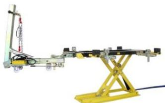
**1330BC PH.1ROTELSC06** JOLLIFT Hebebühne (Überflur) und Richtbank, komplett mit Hebebühne, 3.000 kg Tragkraft, Hubhöhe eff. 1.300mm, Überfahrhöhe 105mm, 2,20m lang, 1 Steuerpult **pneumohydraulisch**, 4m Leitung, 4 schwenkbare Aufnahmearme, 4 Arme für Spannklemmen, 4 kleine Aufnahmeklemmen in der Höhe bis 10 cm verstellbar, 1 Zugerät mit effektiv 5 T Zugkraft, 8 Gummiauflagen
