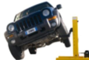
**Easylift** Easylift 3000 ist eine mobile hydraulische Hebesäule. Geeignet um Fahrzeuge mit bis zu 3.000Kg am Rad oder an der Schwellerkante zu heben. Der Antrieb erfolgt Pneumohydraulisch über einen Zylinder und einer Kette. Durch den hydraulischen Antrieb optimal für den Einsatz in Karosserie und Lackbetrieben. Im Lieferumfang ist die fahrbare Hebesäule mit Hydraulikpumpe, Radaufnahme und Schwellerkantenaufnahme
