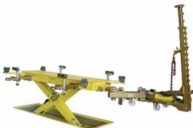
**Jollift Flex35.10TFL08** JOLLIFT Hebebühne (Unterflur) und Richtbank, komplett mit Hebebühne, 3.500 kg Tragkraft, Hubhöhe eff. 1.640mm, Einbauhöhe 300mm, 2.36m lang, 1 Steuerpult **elektrohydraulisch**, 5m Leitung, 4 schwenkbare Aufnahmearme, 4 Arme für Spannklemmen, 4 Aufnahmeklemmen in der Höhe bis 30cm verstellbar, 1 Zugerät doppelt drehbar mit effektiv 10 T Zugkraft, 8 Gummiauflagen
